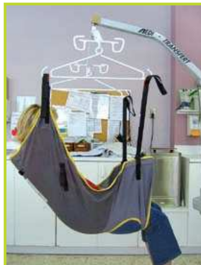
13. Certains leviers exigent l'utilisation de cintres supplémentaires afin de se rendre jusqu'au sol.
